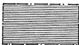
Baufensterfläche, in der das Gebäude mit der angegebenen maximalen Grundfläche errichtet werden darf.
